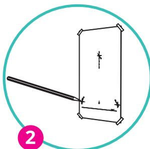
Brug boreskabelonen til at afmærke der hvor der skal bores på væggen og sæt de 3 fæstetapper ind i hullerne
