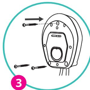
3 Ota **easyWallbox** (irrotta kansi) ja kiinnitä kolme ruuvia kiinnitystulppiin.
