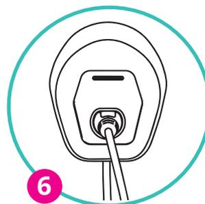
Når den BLÅ lysdiode er tændt, er din **easyWallbox** klar til at blive brugt i Plug & Play tilstand (op til 2.3 kW)
