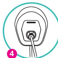
Po zakończeniu instalacji, zawsze postępując zgodnie z **instrukcją Instalatora**, włącz zasilanie i poczekaj, aż zaświeci się **NIEBIESKA** dioda LED.
