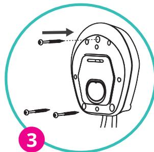
Ta **easyWallbox** (ta bort det estetiska locket) och fäst de tre skruvarna i fästpluggarna
