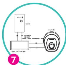
Jeśli wymagana jest instalacja funkcji Dynamic Power Management (DPM), zainstaluj czujnik prądu i włącz przycisk w aplikacji.
