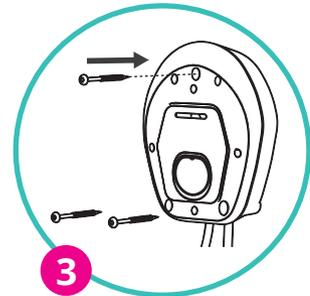
Nehmen Sie die **easyWallbox** (ästhetische Abdeckung entfernen) und befestigen Sie die 3 Schrauben in den Befestigungsdübeln
