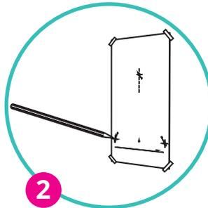
Markieren Sie mit der Bohrschablone, wo an der Wand gebohrt werden soll und stecken Sie die 3 Befestigungsdübel in die Löcher
