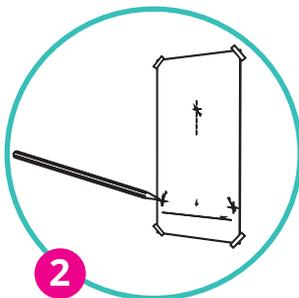
Utilizando o escantilhão de perfuração, marcar onde perfurar na parede e inserir as 3 tomadas fixas macho nos furos
