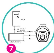
Om installation av Dynamic Power Management (DPM) krävs, installera strömgivaren och slå på knappen i appen.
